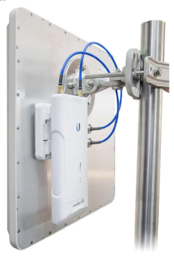
Ce genre d'installation permet de créer des ponts Wifi. © MHz
